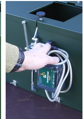
Trapmaster „Standard“ mit Sensorkabel (Kabel darf den Auslösemechanismus nicht behindern).
