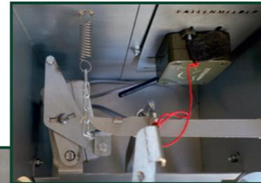
Im abschließbaren Auslösekasten integriert, spielfreie Verbindung zwischen Auslösewippe und Auslöser.
