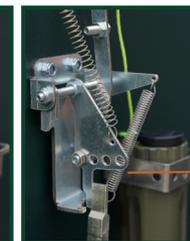
Auslösegewicht 4-fach werkzeuglos einstellbar, einfache Bedienung, Wippe nach dem Fang arretiert automatisch
