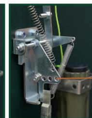
Auslösegewicht 4-fach werkzeuglos einstellbar, einfache Bedienung, Wippe nach dem Fang arretiert
