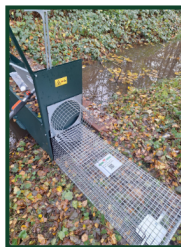
Haken am Fallenschieber zur schnellen Arretierung des Abfangkorbs
